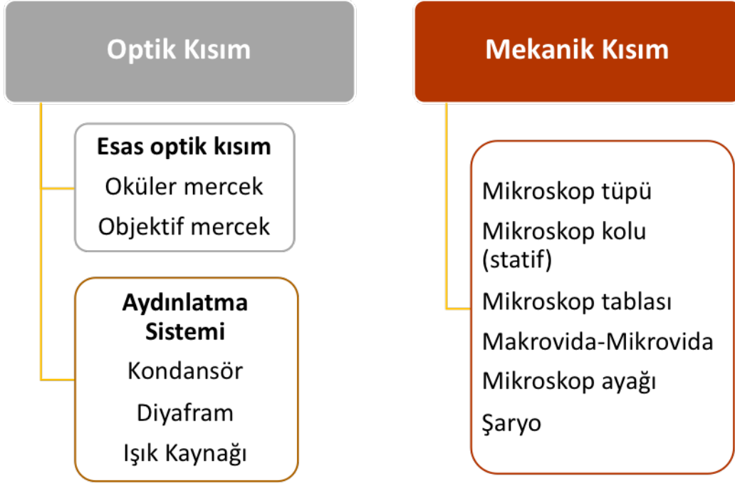
Şekil 1. Işık mikroskobunun kısımları
