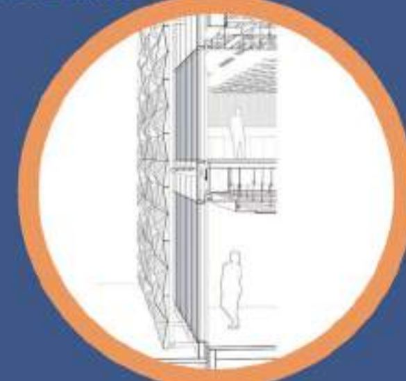
3. CEPHE PANELLERİNİN BİNAYA BAĞLANMA DETAYI
