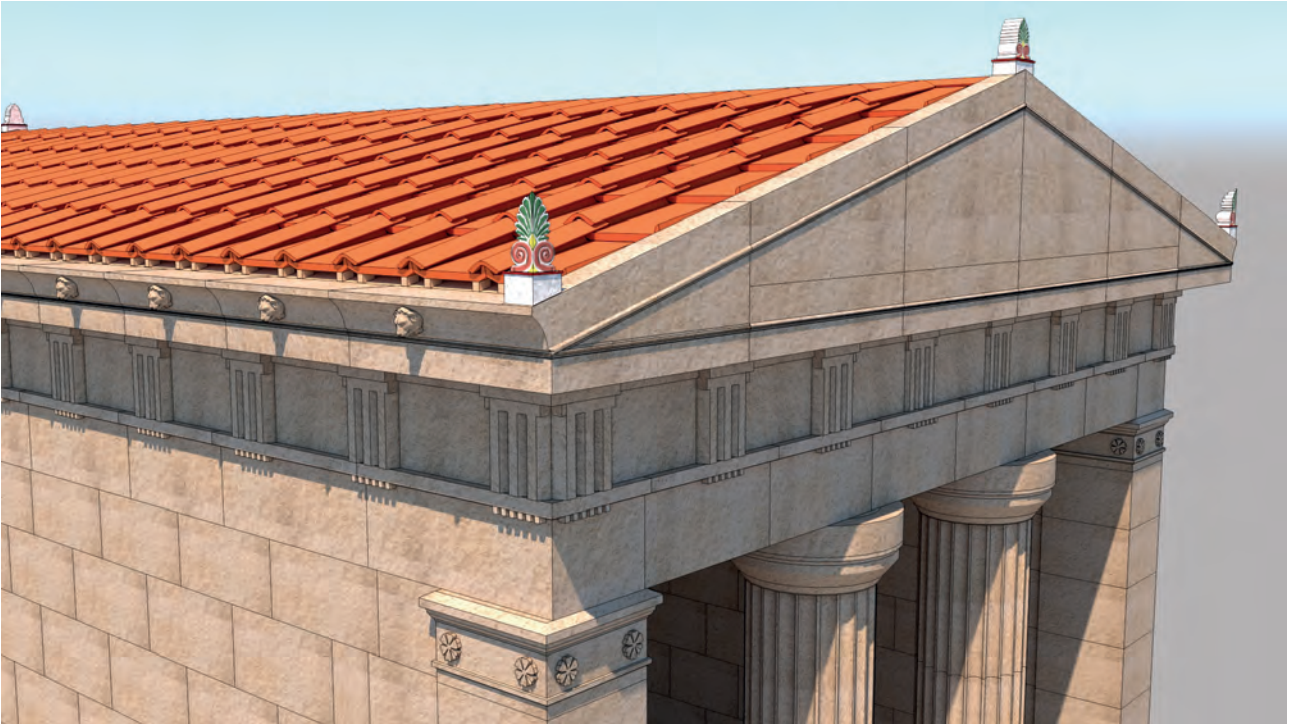
Resim 49. Kiremit (stroter) ve kaplama kiremit (kalypter) detayları
