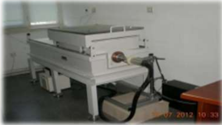
Yüksek saflıktaki Germanyum Dedektörü (p-tipi, elektriksel soğutmalı HPGe gama ışın spektrometresi)
